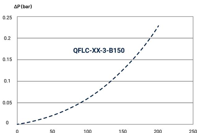
Perte de charge à 20°C pour une viscosité de 1 cP
