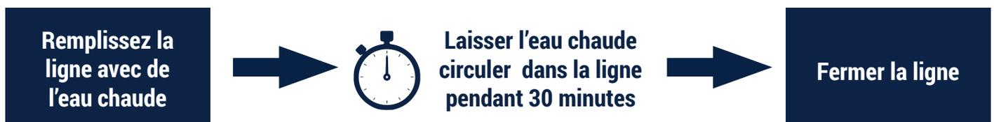
Si la ligne de filtration n'a pas besoin de redémarrer immédiatement, **laissez-la refroidir remplie d'eau chaude pour éviter tout choc thermique des éléments filtrants.**
