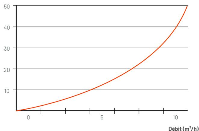
\*Pertes de charge initiale typique  $\Delta P$  par élément de 10", eau à 20°C, viscosité 1cP.
