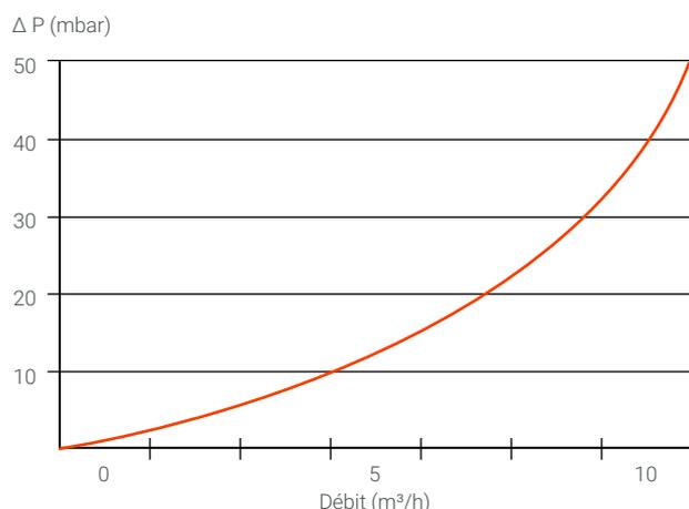
Perte de charge initiale typique  $\Delta P$  par élément de 254mm (10"), eau à 20°C, viscosité 1cP.
